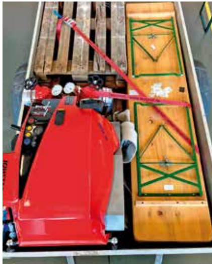
Ladungssicherung für einen Wettkampf zum Lösch-Angriff Nass auf einem handelsüblichen PKW-Anhänger
