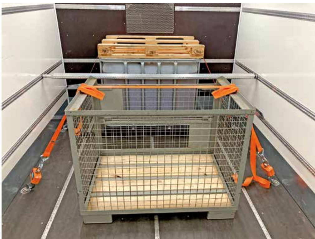
Ladungssicherung auf einem Wechselladerfahrzeug der Feuerwehr im Ladungssicherungsseminar der FUK BB
